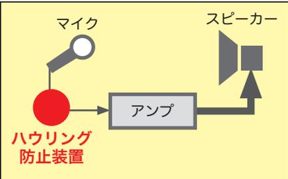
この装置は、マイクが拾ってしまうハウリングの原因となる発振現象を検知して自動的にカットするため、人の声はそのままに、ハウリングの無い環境を実現します。既設の機器を買い換える事なく、ハウリング防止装置を追加するだけであの嫌なハウリングから解放されます！
